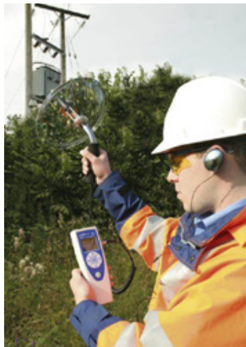
Obrázek 1: Detekce časově- tečných výbojů pomocí jednobodového detektoru a parabolické antény [4]
