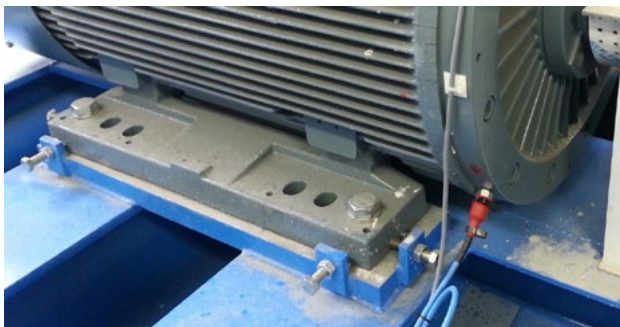
Obrázek 3: Příklad ne zcela vhodně umístěných odtlačovacích šroubů (vzhledem ke konstrukci stroje) způsobujících komplikace při vkládání a odebírání podložek
