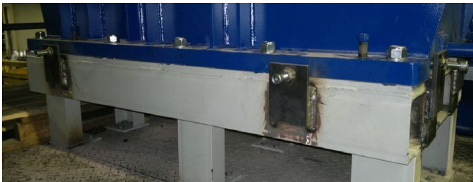
Obrázek 5: Příklad obtížného přístupu ke kotevnímu šroubu (prostřední kotevní šroub je „dosažitelný“ pouze z boku frémy otvorem v nosníku cca 12 × 10 cm na vzdálenost přesahující délku paže)
