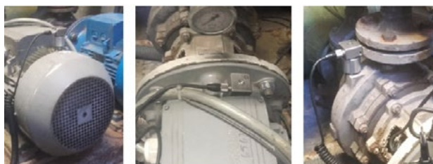
Obrázek 5: Měřicí místa na elektromotoru a čerpadle č. 23, L1 (vlevo), L2 (uprostřed), L3 (vpravo) [7]
