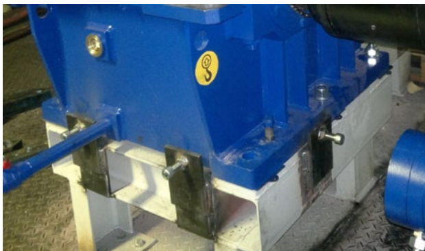
Obrázek 2: Příklad úzké frémy s vyčnívajícími podložkami
