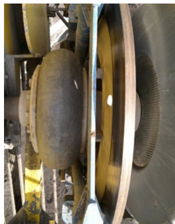
Obrázek 4: Příklad konstrukce stroje a jeho příslušenství s výrazným prostorovým omezením pro instalaci komponent pro ustavování na straně elektromotoru
