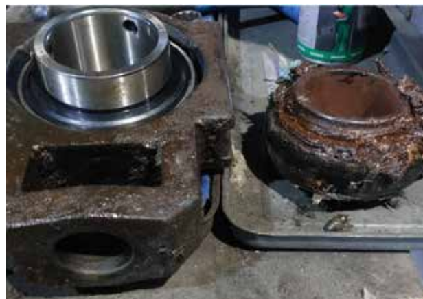
Obr. 3: Stav ložiska po výměně v plánované odstávce (vpravo) a nově montovaného ložiska v ložiskovém tělese (vlevo)
