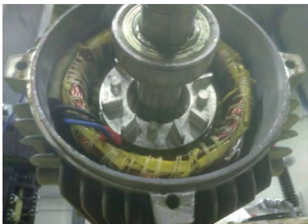
Obr. 1 Připojení zkušebních vývodů k satorovému vinutí
