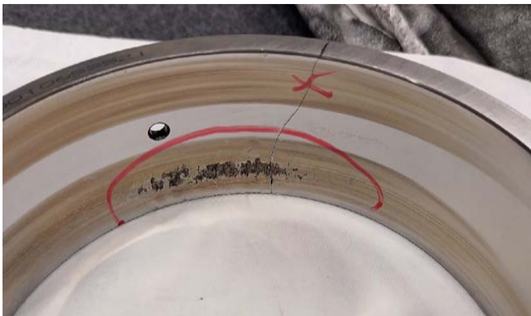
Obr.3 Snímek rozsahu poškození ložiska na vnějším kroužku - prasklina způsobena při neodborné demontáži ložiska.
