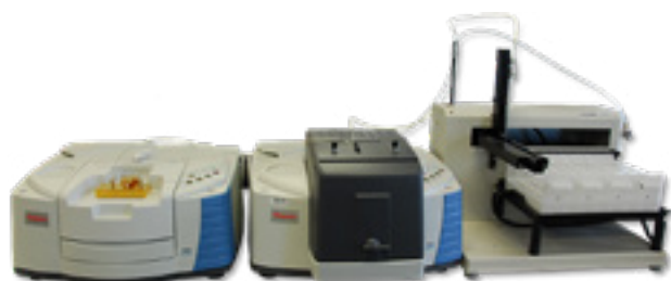
Obrázek 1: FTIR spektrometr Nicolet iS10iZ10 s autosamplerm
