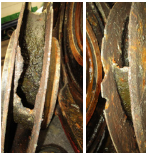
Obrázek č. 3: Poškozená oběžná kola odstředivého čerpadla
