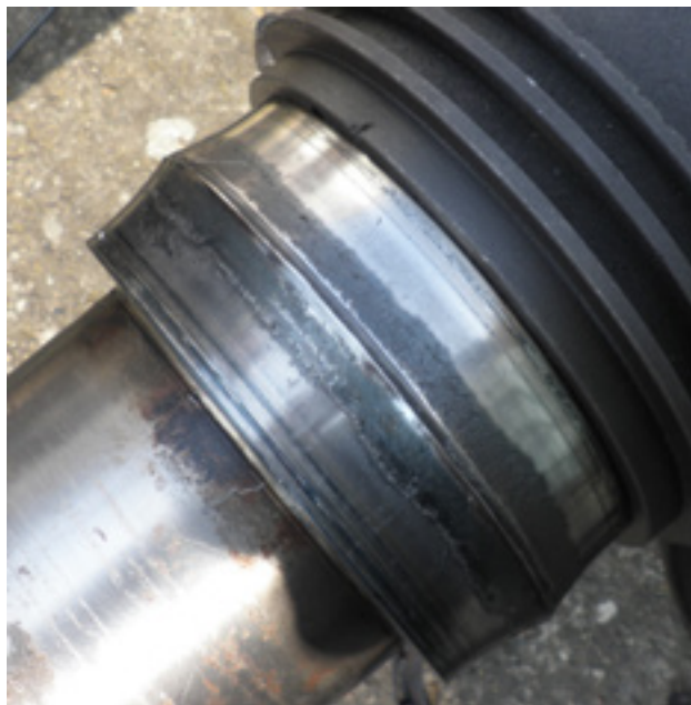
Obrázek č. 4: Poškozené ložisko ventilátoru po demontáži
