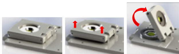
Obrázek 2a: Horizontální kapalinová kyveta se ZnSe okénky – detail
