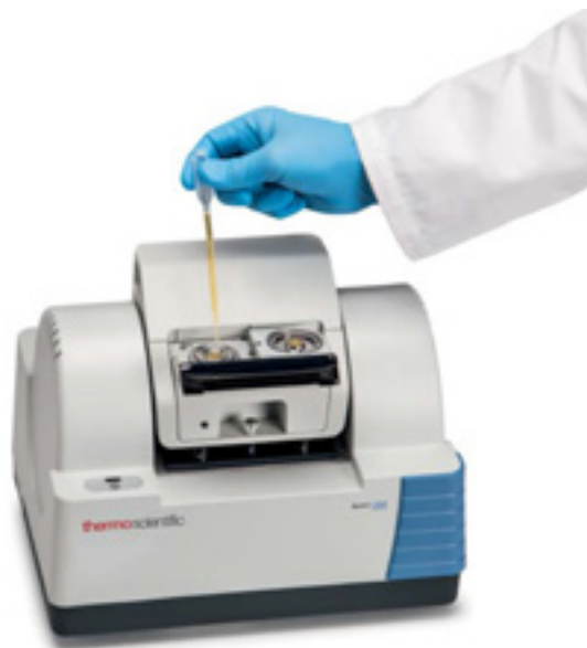
Obrázek 2 b: Horizontální kapalinová kyveta se ZnSe okénky
