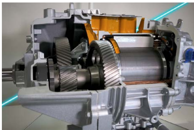
Obr. 4 : Pohonný elektroagregát vozidla [2]
